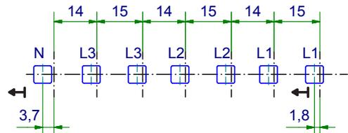
Das einzigartige und zugleich innovative Merkmal ist der seitliche Versatz der Zähleranschlussstifte von bis zu 3,6 mm (1,8 mm je Seite). Dadurch können alle derzeit verwendeten Energiezähler und Smartmeter mit der Anschlussklemme SL-ZAKD angeschlossen werden.
