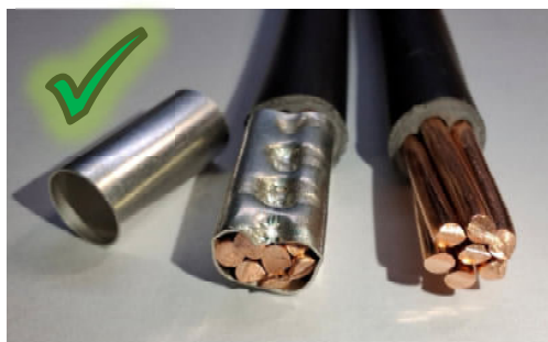
Leitervergleich nach ordnungsgemäßer Verpressung
