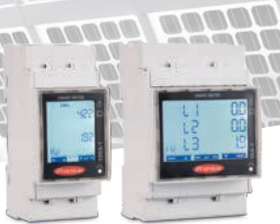
Der Fronius Smart Meter TS ist ein bidirektonaler Zähler zur Optimierung des Eigenverbrauchs, zur Erfassung der Lastkurve und zur Steuerung der verschiedenen Energieflüsse. Dank hoher Messgenauigkeit und schneller Kommunikation über die Schnittstelle Modbus RTU wird bei Einspeisebegrenzungen eine schnellere und genauere dynamische Einspeiseregelung als bei S0-Zählern ermöglicht.
