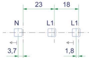
Das einzigartige und zugleich innovative Merkmal ist der seitliche Versatz der Zähleranschlussstifte von bis zu 3,6 mm (1,8 mm je Seite). Dadurch können alle derzeit verwendeten Energiezähler und Smartmeter mit der Anschlussklemme SL-ZAKW angeschlossen werden.
